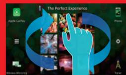
Contrôle du volume avec mouvement circulaire.
